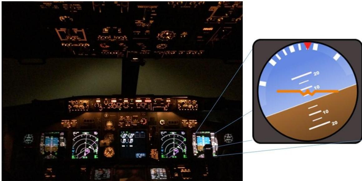
Figure 9. Parmi les instruments de bord dans le cockpit d'un avion, l'indicateur d'assiette constitue un outil essentiel pour contrôler l'orientation et le déplacement de l'aéronef, en particulier en navigation nocturne. Celui-ci spécifie visuellement l'horizon physique, plan-référence fixe dans l'espace géocentré, permettant de contrôler l'orientation de l'appareil en tangage et en roulis.
